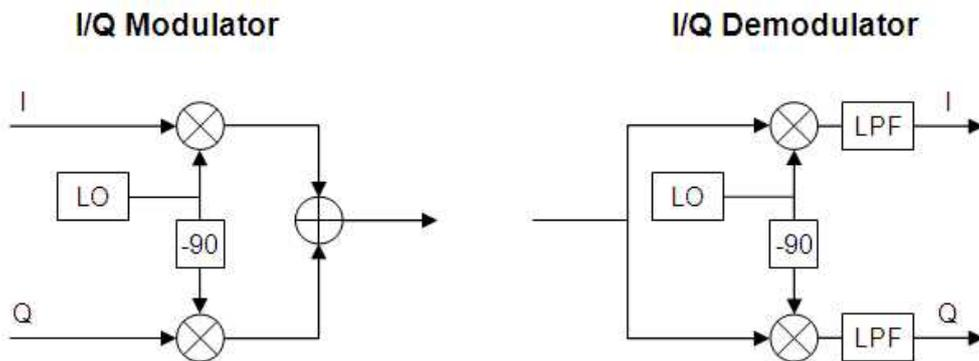
FIGURE 4.1 – Modulateur IQ et son démodulateur permettant de transmettre deux signaux modulateurs  $i(t)$  et  $q(t)$  (notés I et Q dans la figure) autour de la fréquence porteuse générée par l'Oscillateur Local (LO)  $\cos(\omega_p \cdot t)$ . Le bloc  $-90$  est un déphaseur de  $-\pi/2$  qui transforme le cosinus du LO dit I en sinus dit Q. Les blocs en X sont des multiplieurs et celui en + un sommateur.
